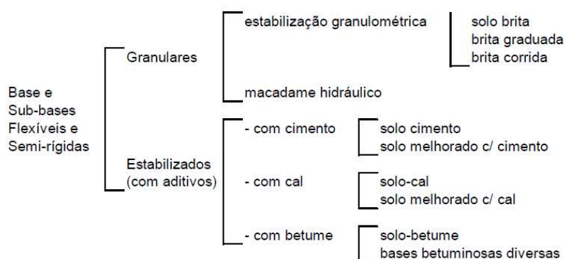
Figura 5 – Classificação das bases e sub-bases.
